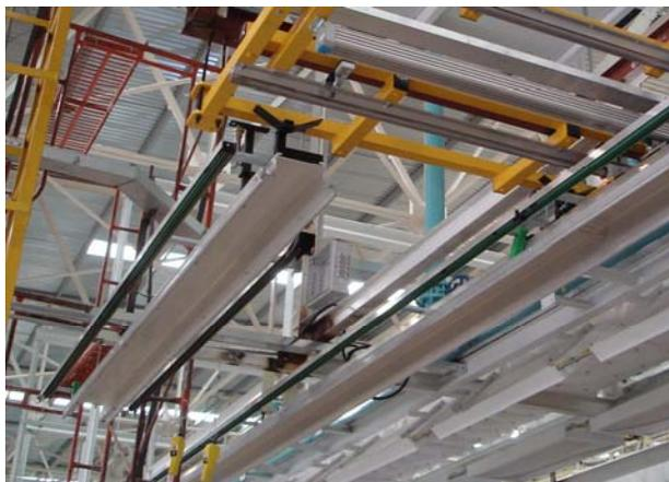
Rückführschiene mit Stromschiene
