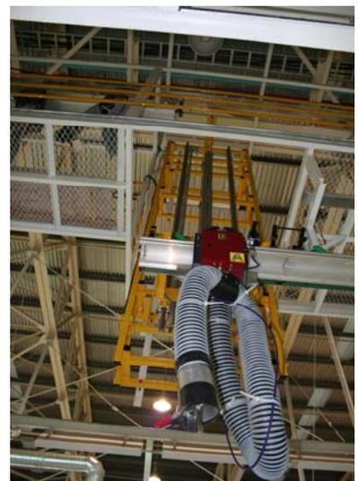
Die vollautomatische Hubstation ermöglicht den Transfer von Schlauchwagen zwischen zwei verschiedenen Ebenen. Dadurch wird eine maximale und ergonomische Raumnutzung in der Automobilindustrie erreicht. Höchste Sicherheit dank doppelt wirkenden Verriegelungen, Endschaltern und Überlastschutz.
